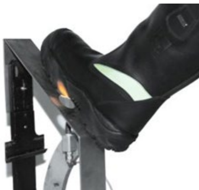
Figura 13. Determinação da resistência à chama em calçado de bombeiro.
