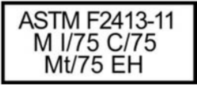
Figura 9. Marcação do calçado de segurança, de acordo com a ASTM F2413-11.
