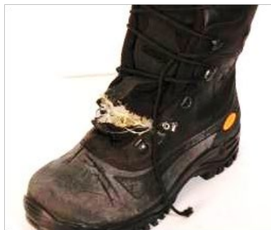
Figura 16. Imagem do corte na zona da garganta num calçado resistente ao corte por motosserra.
