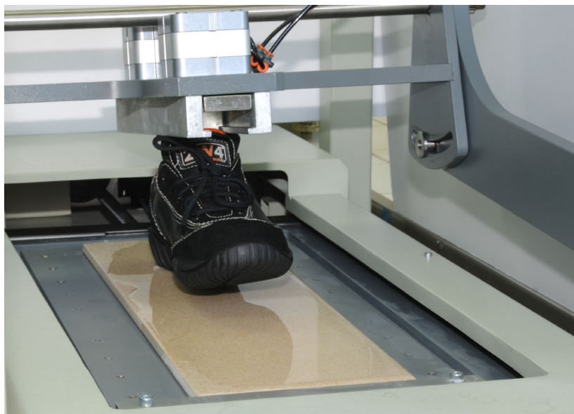
Figura 6. Método de ensaio de determinação da resistência ao escorregamento do calçado.
