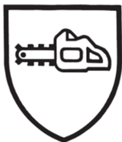
Figura 17. Pictograma para marcação CE de calçado com resistência ao corte por motosserra.
